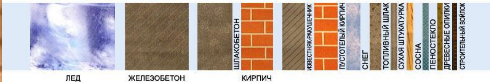
ШКАЛА ТОЛЩИНЫ МАТЕРИАЛОВ ПРИ ОДИНАКОВОЙ ТЕПЛОПРОВОДНОСТИ
