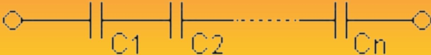
Эта ёмкость всегда меньше минимальной ёмкости конденсатора, входящего в батарею. Однако при последовательном соединении уменьшается возможность пробоя конденсаторов, так как на каждый конденсатор приходится лишь часть разницы
