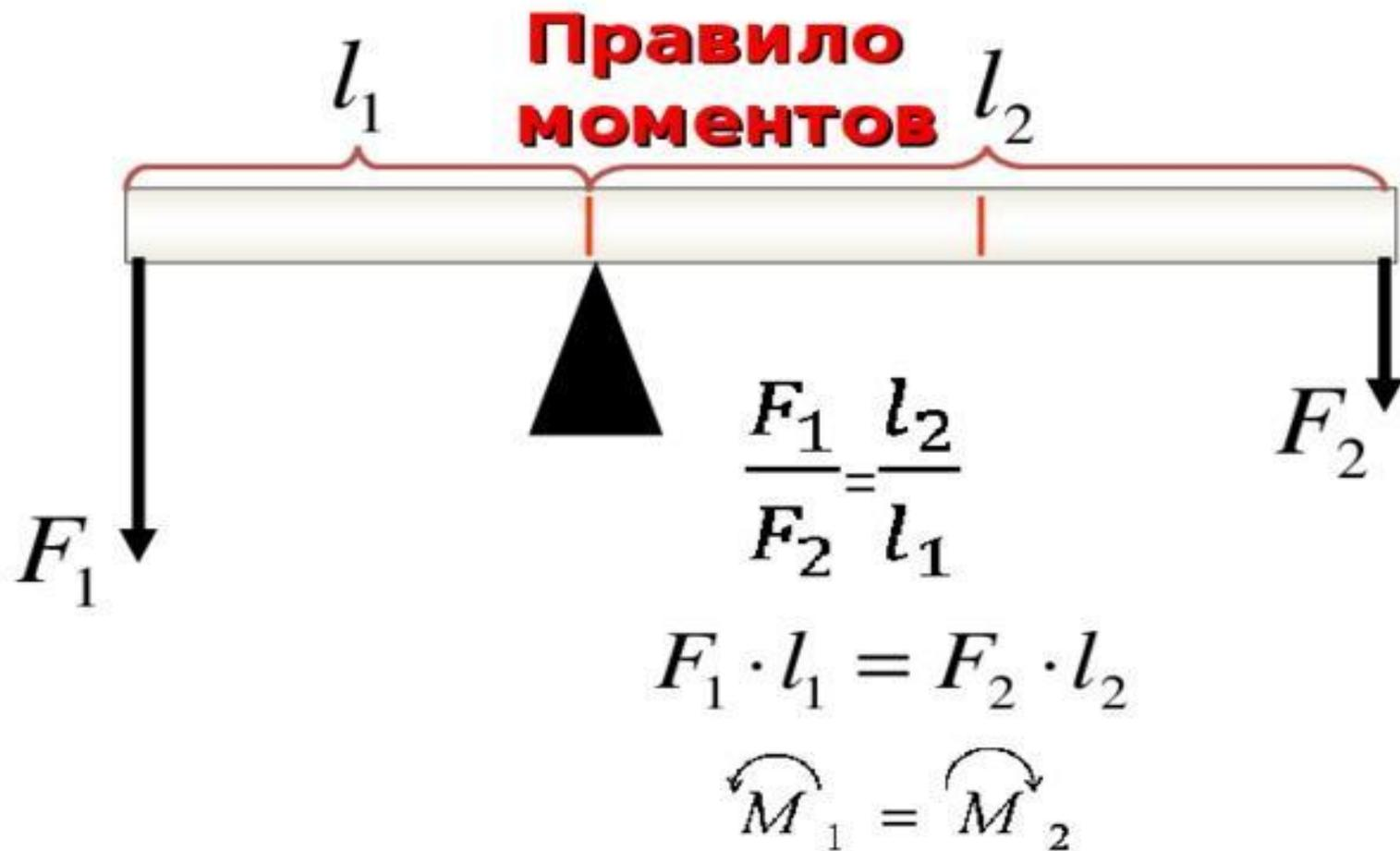
Рычаг находится в равновесии под действием двух сил, если момент силы, вращающий его по часовой стрелке, равен моменту силы, вращающий его против часовой стрелки.
