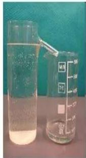
При погружении тела в отливной стакан с водой, вода выливается. Объем этой воды равен объему погруженного тела.
