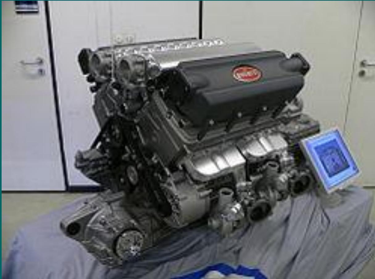
Бензиновые двигатели — это класс двигателей внутреннего сгорания, в цилиндрах которых предварительно сжатая топливовоздушная смесь поджигается электрической искрой.
