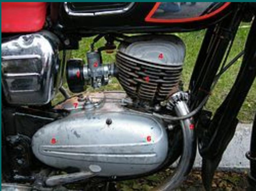
Двухтактный двигатель — поршневой двигатель внутреннего сгорания, в котором рабочий процесс в каждом из цилиндров совершается за один оборот коленчатого вала, то есть за два хода поршня
