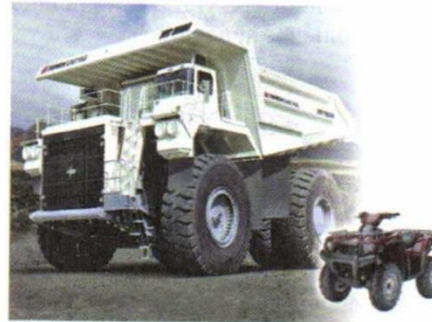
Рис. 91. Увеличение площади опоры для уменьшения давления на поверхность
