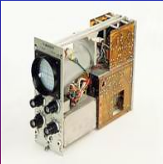
Электронно-лучевая трубка осциллографа
