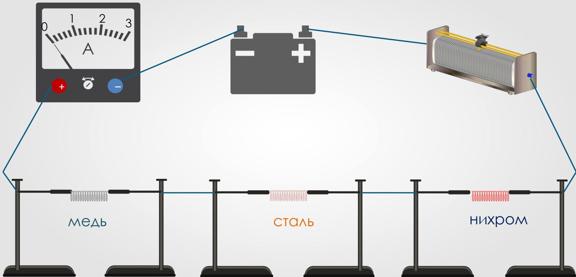
**Спирали** нагревательных приборов изготавливаются из нихромовой проволоки.
