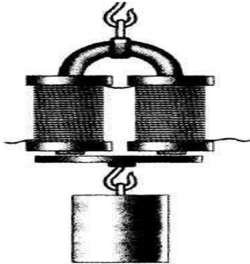
Дугообразный электромагнит, удерживающий якорь (железную пластинку) с подвешенным грузом.
