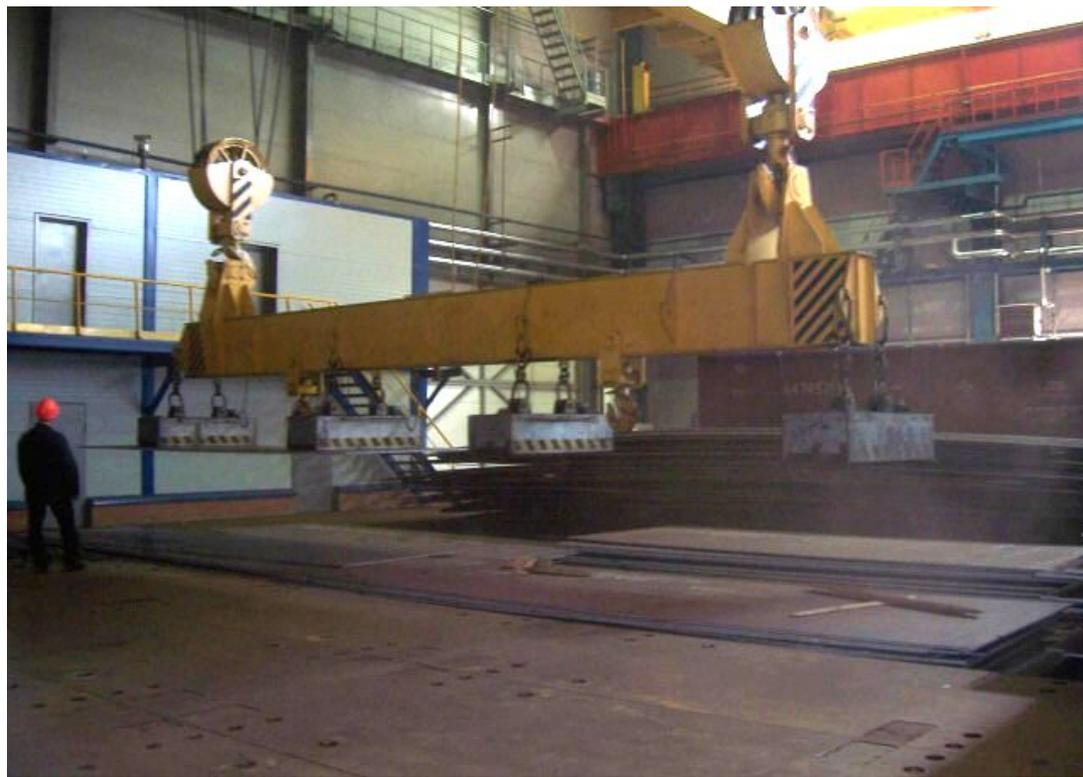
Электромагнитные траверсы используются для перемещения длинномерных грузов.
