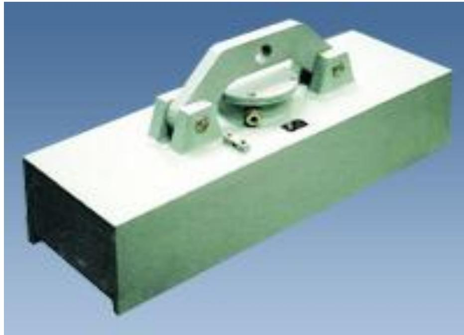
Прямоугольные электромагниты предназначены для захвата и удержания при транспортировании листов, рельсов и других длинномерных грузов.
