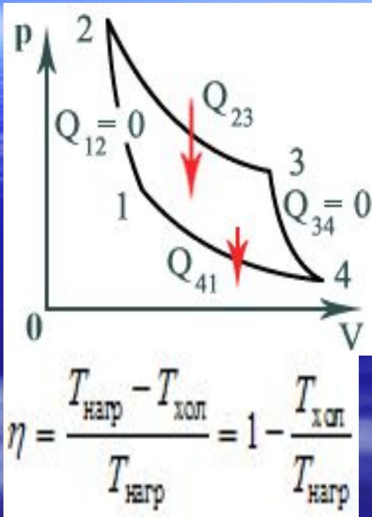
Наибольшим КПД при заданных температурах нагревателя  $T_{\text{нагр}}$  и холодильника  $T_{\text{хол}}$  обладает тепловой двигатель, где рабочее тело расширяется и сжимается по циклу Карно график которого состоит из двух изотерм (2–3 и 4–1) и двух адиабат (3–4 и 1–2).
