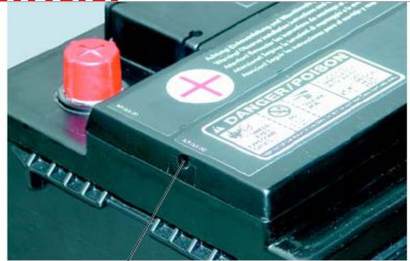
Отверстия центральной системы вентиляции
