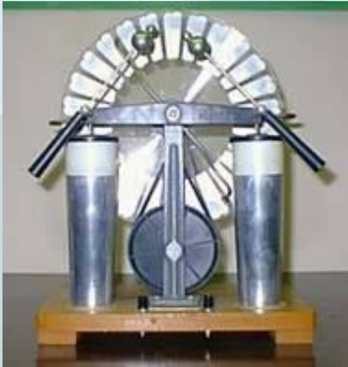
До конца XVIII века все технические источники тока были основаны на электризации трением. Наиболее эффективным из этих источников стала *электрофорная машина* (диски машины приводятся во вращение в противоположных направлениях; в результате трения щеток о диски на кондукторах машины накапливаются заряды противоположного знака).
