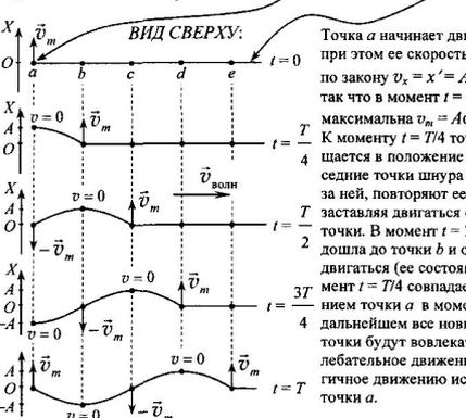
Точка  $a$  начинает двигаться, при этом ее скорость меняется по закону  $v_x = x' = A\omega \cos \omega t$ , так что в момент  $t = 0$  скорость максимальна  $v_m = A\omega$ .
