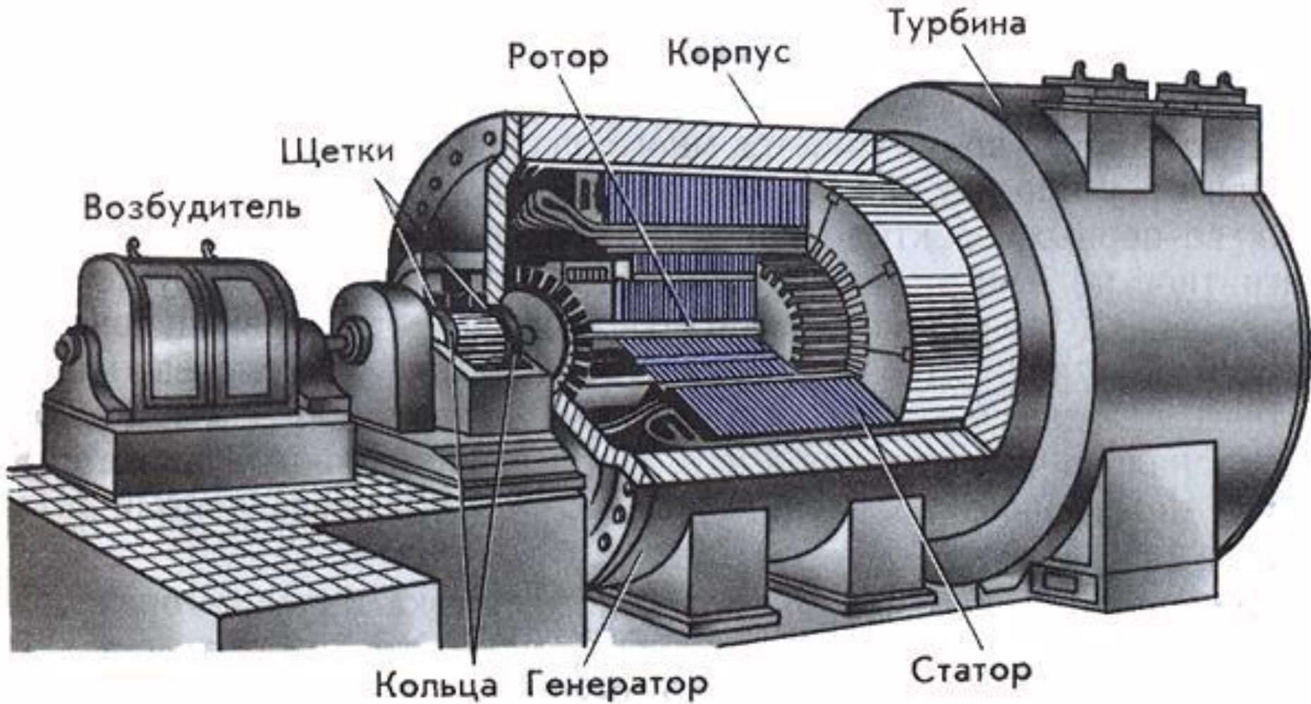
ГЕНЕРАТОРА ВРАЩАЕТСЯ С ПОМОЩЬЮ ПАРОВОЙ ТУРБИНЫ, НА ГИДРОЭЛЕКТРОСТАНЦИЯХ С ПОМОЩЬЮ ВОДЯНОЙ ТУРБИНЫ.
