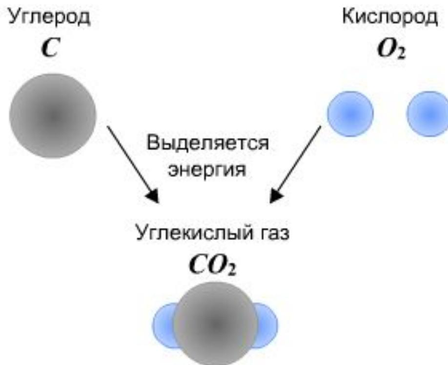
**Удельная теплота сгорания топлива** – физическая величина, показывающая, какое количество теплоты выделяется при полном сгорании топлива массой 1 кг
