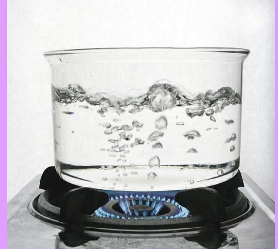
*При конвекции энергия переносится самими струями газа и жидкости.*
