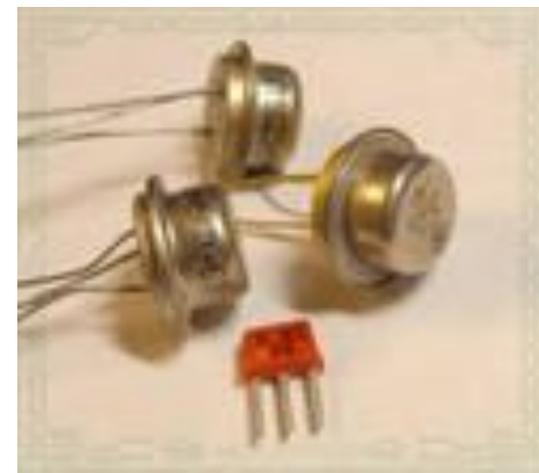
**Транзистор** – полупроводниковый активный прибор, применяемый для усиления и генерации сигналов
