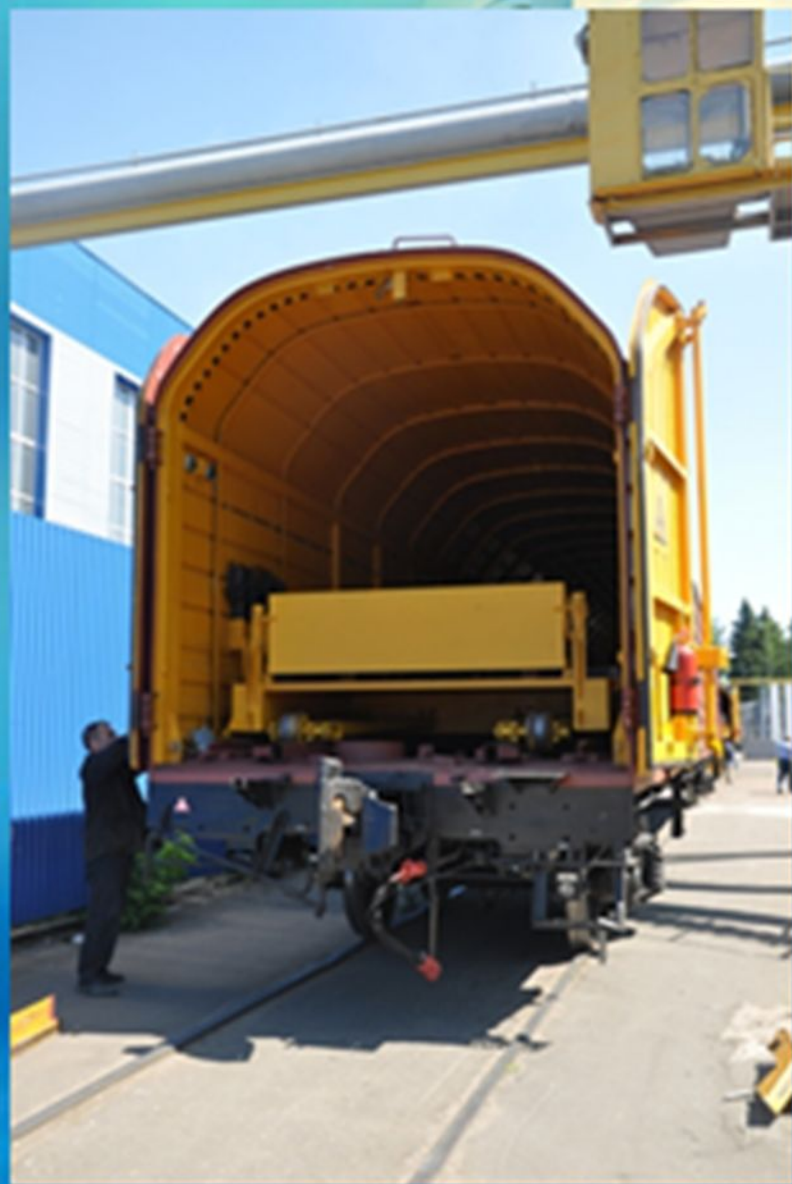
Вагон для перевозки ядерного топлива
