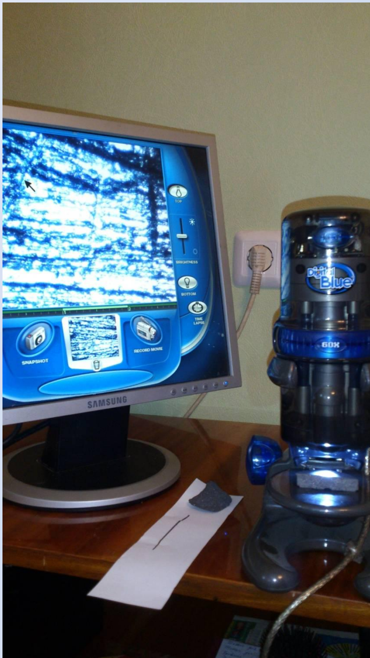
Кристаллическая структура железа (увеличение x60)
