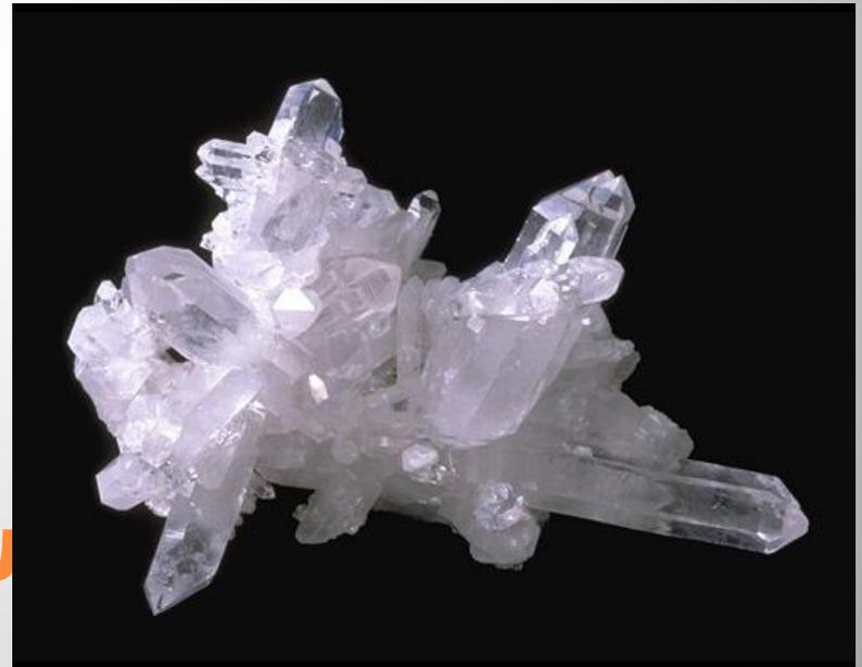
Характерная особенность кристаллического состояния, отличающая его от жидкого и газообразного состояния, заключается в наличии анизотропии, т.е зависимости ряда свойств от направления. Тела, свойства которых одинаковы по всем направлениям, называются изотропными. Изотропны кроме газов также аморфные твердые тела.
