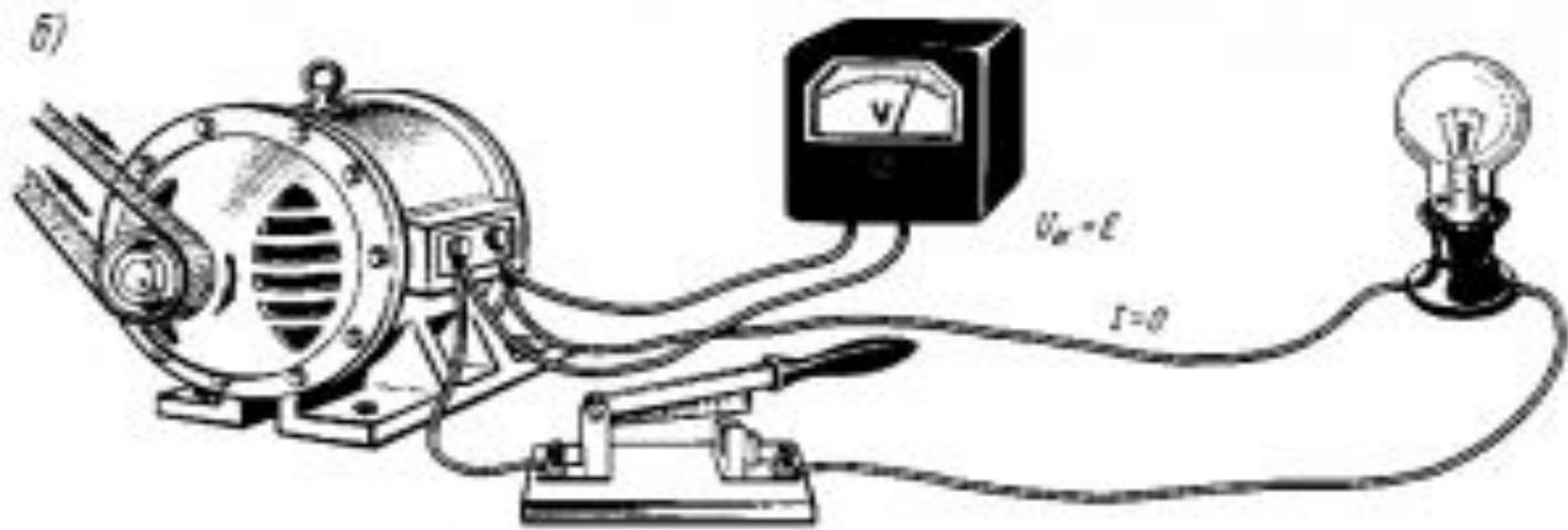
При этом режиме присоединенная к источнику электрическая цепь разомкнута, т. е. тока в цепи нет. В этом случае внутреннее падение напряжения  $IR_0$  будет равно нулю и формула  $E = U_{\text{и}} + IR_0$  примет вид:
