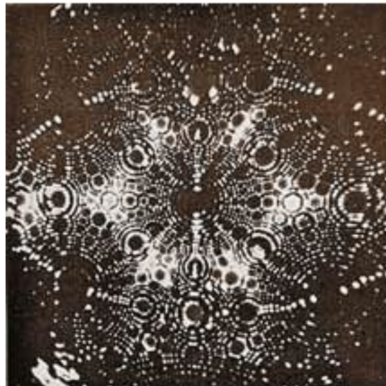
острие металлической иглы внутри ионного микроскопа.
