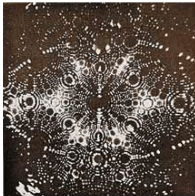
острие металлической иглы внутри ионного микроскопа.
