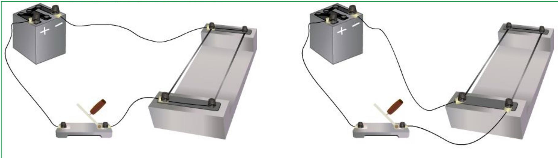
**Два параллельных проводника подсоединили к источнику тока. Оказалось, что между проводниками действуют силы притяжения или отталкивания, в зависимости от того, в каком направлении течет ток по проводникам.**
