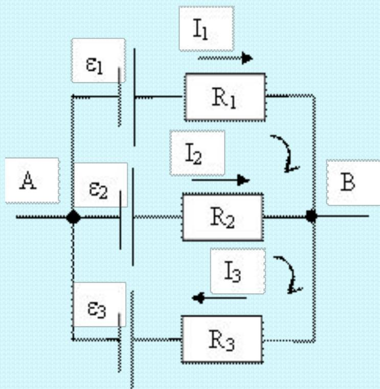
**Задача №5.** Три источника тока с ЭДС  $\varepsilon_1 = 11$  В,  $\varepsilon_2 = 4$  В и  $\varepsilon_3 = 6$  В и три реостата с сопротивлениями  $R_1 = 5$  Ом,  $R_2 = 10$  Ом,  $R_3 = 20$  Ом соединены как показано на схеме. Определить силы токов  $I$  в реостатах. Внутреннее сопротивление источника пренебрежимо мало.
