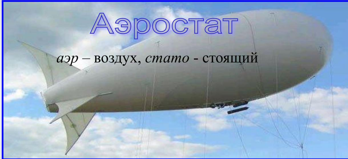
Аэростаты уже более 70 лет успешно используются как «вышка» для передачи, ретрансляции и приема сигнала. Первые работы по передаче радиосигналов с привязных аэростатов, поднятых на высоту 2-3 км, начали проводить еще в 30-х годах 20-го века.
