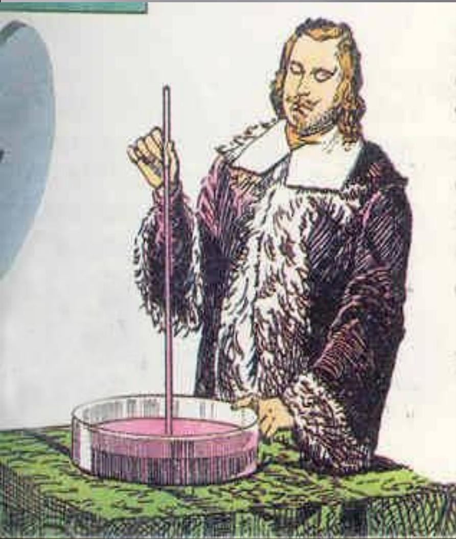
Первое измерение атмосферного давления было проделано в 1643 г. учеником Галилея В. Вивиани по указанию итальянского физика Э. Торричелли. В этом опыте запаянная с одного конца и заполненная ртутью стеклянная трубка длиной около метра переворачивалась и опускалась в другой сосуд с ртутью. Высота столба ртути в трубке понижалась до высоты около 760 мм над уровнем ртути в широком сосуде (при этом в верхней части трубки над ртутью образовывалось безвоздушное пространство — «торричеллиева пустота»).
