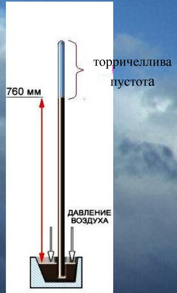
Опыты с более тяжелой жидкостью - ртутью, предпринятые в 1647г. Торричелли, привели к открытию атмосферного давления, которое равно давлению столба ртути в трубке:
