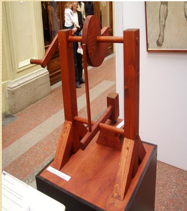
Механический молоток, изобретён Леонардо да Винчи
