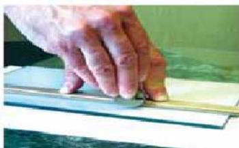
Рис. 9.3. Резка стекла алмазом
