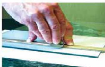
Рис. 9.3. Резка стекла алмазом
