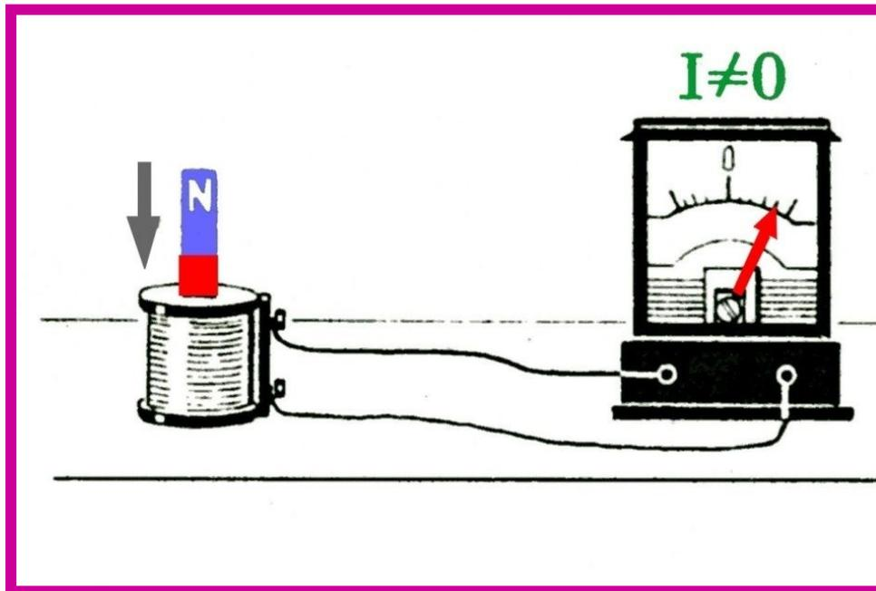
ЭДС в замкнутом контуре  $L$  численно равна работе сил электрического поля при перемещении единичного положительного заряда вдоль этого контура
