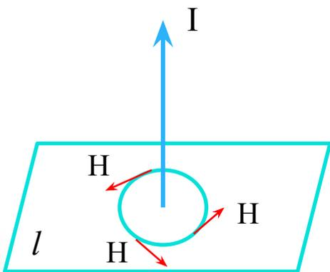
Циркуляцию  $\vec{H}$  вдоль произвольного замкнутого контура  $l$ , охватывающего ток:
