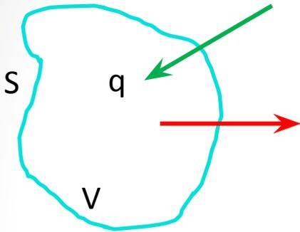
Изменение заряда внутри данного объема может происходить за счет втекания или вытекания зарядов через поверхность, ограничивающую данный объем.
