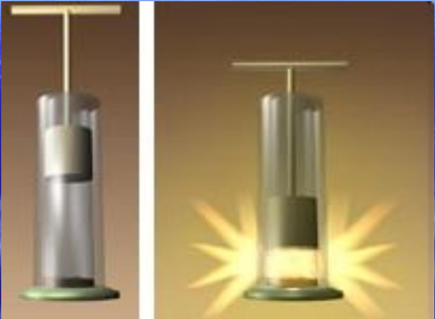
Адиабатным процессом - называется такой процесс, который протекает в системе без теплообмена с внешней средой
