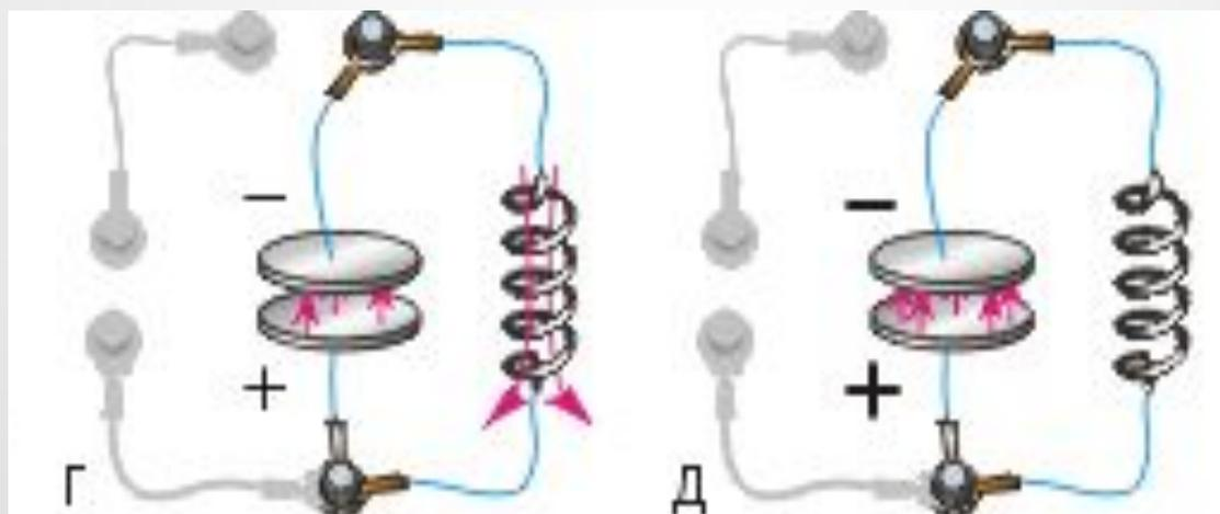
Теперь, когда конденсатор вновь заряжен, он может снова создавать ток, правда, уже противоположного направления (рис. «е»). Так будет повторяться до тех пор, пока вся энергия, полученная конденсатором от источника тока, не превратится в теплоту.
