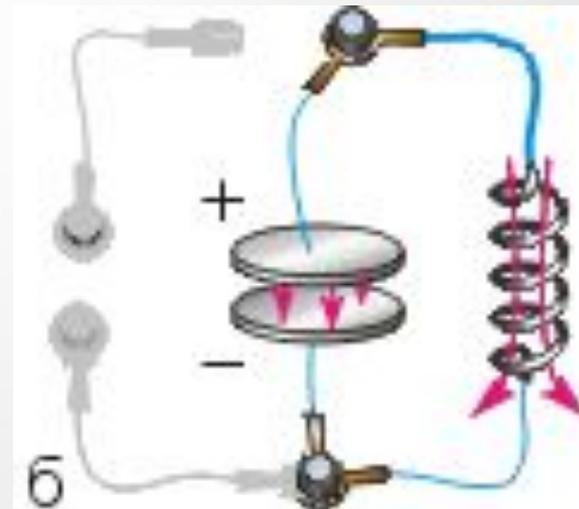
Возникающий при разрядке конденсатора ток непостоянен, значит, непостоянно и магнитное поле катушки. Оно усиливается и достигает максимума, когда конденсатор полностью отдаст свой заряд (рис. «в»). Следовательно, энергия электрического поля конденсатора полностью превратится в энергию магнитного поля катушки
