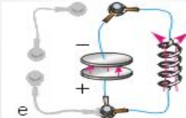
При периодическом изменении силы тока в колебательном контуре происходит периодическое изменение магнитного поля. Модуль вектора маг. индукции имеет наибольшее значение, когда сила тока максимальна. При этом конденсатор не заряжен, эл. поле отсутствует. Когда заряд конденсатора максимален, эл. поле максимально, то эл. ток и маг. поле отсутствуют.
