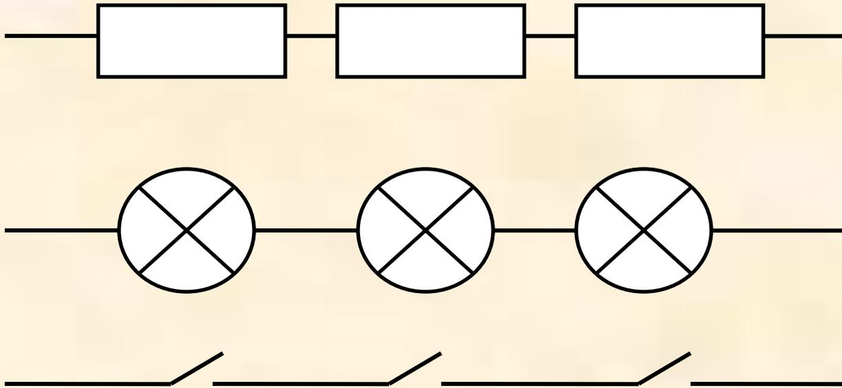
Особенность последовательного соединения – это отсутствие разветвления: «конец» первого провода соединен с «началом» второго и т.д.
