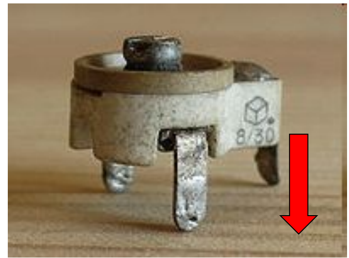
Керамический подстроечный конденсатор
