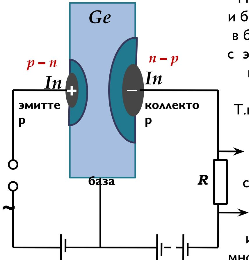
При создании напряжения между эмиттером и базой, основные носители - дырки, проникают в базу, где небольшая часть их рекомбинирует с электронами базы, а основная часть попадает в коллекторный переход, который закрыт для электронов, но не для дырок.
