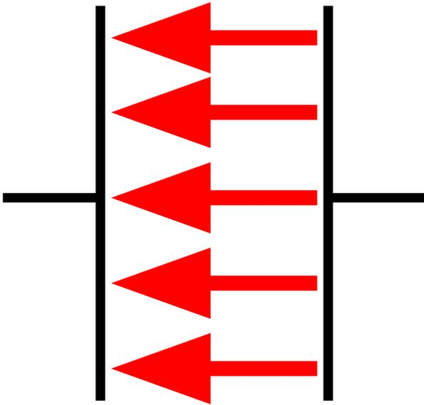
Однородное поле создают большие металлические пластины, имеющие заряды противоположного знака.
