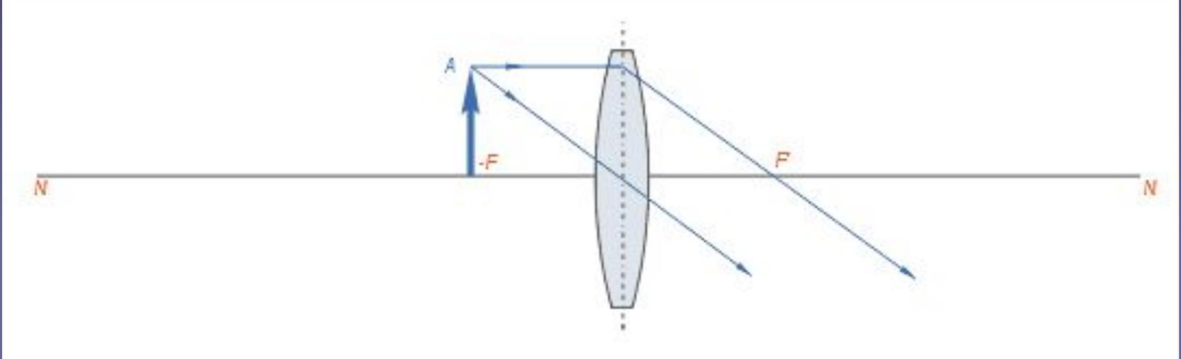
*Если предмет находится в плоскости переднего главного фокуса линзы, то лучи, пройдя через линзу, пойдут параллельно, и изображение может получиться лишь в бесконечности.*
