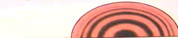
КРИВИЗНА ЛИНЗЫ БОЛЬШЕ КРИВИЗНЫ ПРОБНОГО СТЕКЛА
