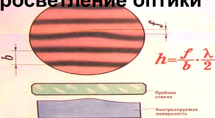
КРИВИЗНА ЛИНЗЫ БОЛЬШЕ КРИВИЗНЫ ПРОБНОГО СТЕКЛА
