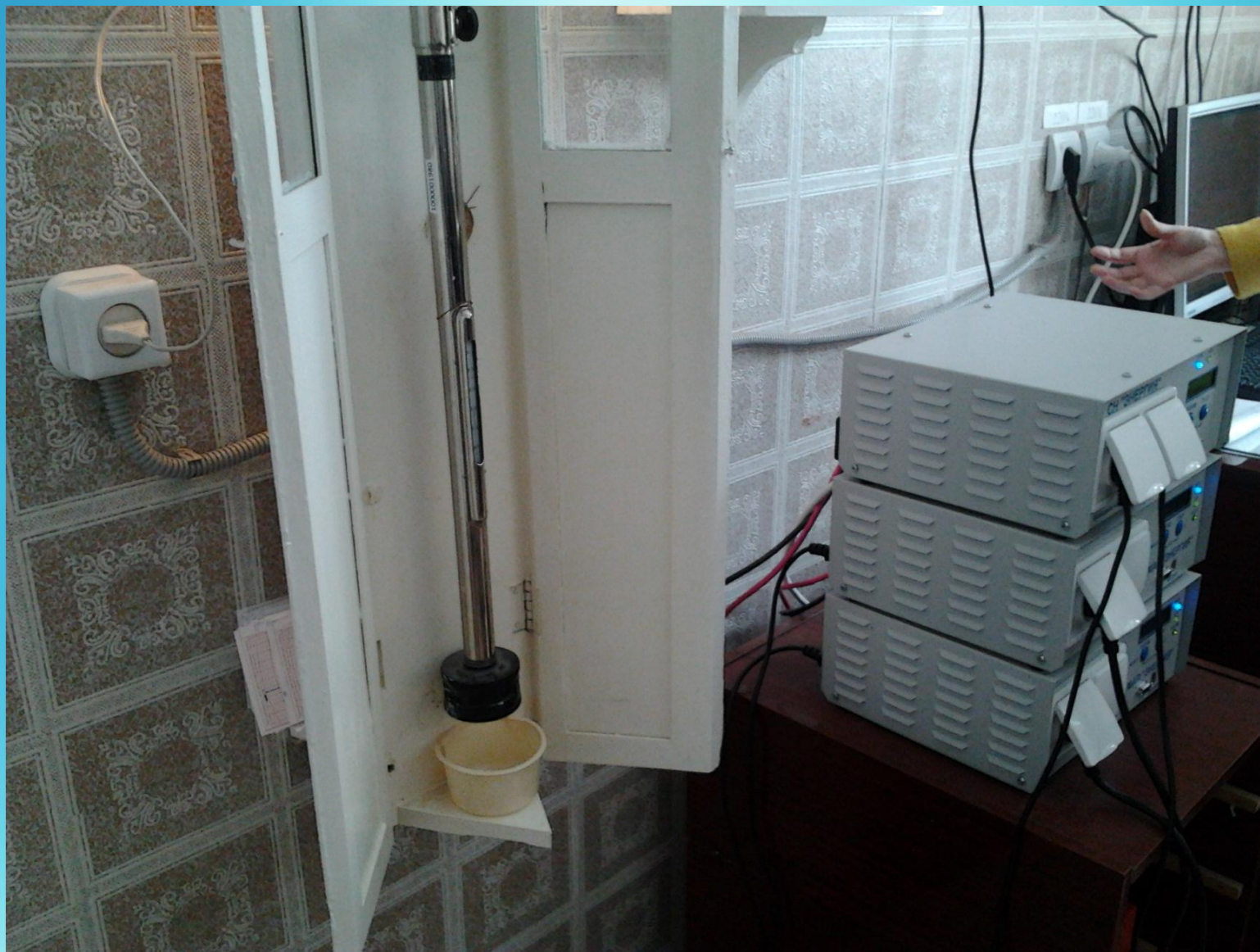
Ртутный барометр на Кумертауской метеостанции
