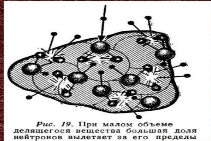
Рис. 19. При малом объеме делящегося вещества большая доля нейтронов вылетает за его пределы
