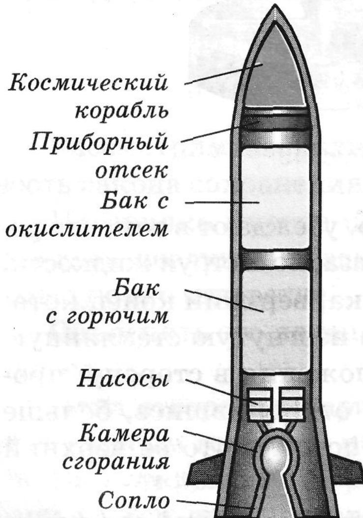
**Сопло** – раструбы специальной формы, через которые газы из камеры сгорания мощной струёй устремляются наружу
