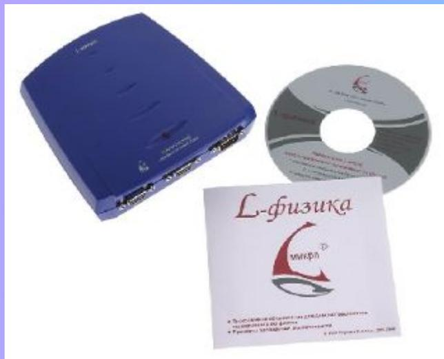
Компьютерный измерительный блок входит в систему учебного оборудования лаборатории L-micro и предназначен для преобразования сигналов, поступающих от датчиков, в цифровой код, который далее обрабатывается в компьютере. Блок подключается к USB порту персонального компьютера и на экране монитора регистрируются результаты измерений в виде графиков и таблиц.
