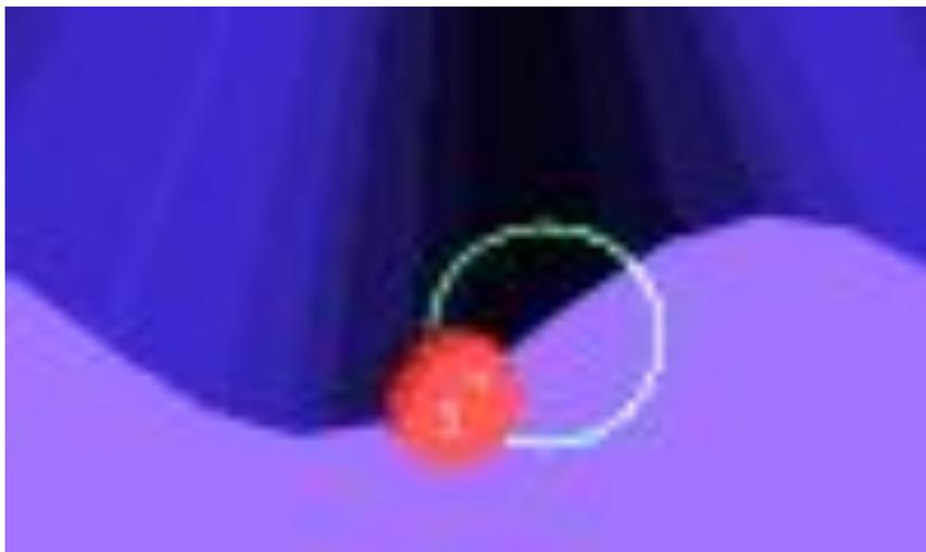
Волны на поверхности жидкости **не являются** ни продольными, ни поперечными. Если бросить на поверхность воды небольшой мяч, то можно увидеть, что он движется, покачиваясь на волнах, по **круговой траектории**. Таким образом, волна на поверхности жидкости представляет собой результат **сложения** продольного и поперечного движения частиц.
