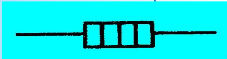
Резистор (проводник, имеющий определённое сопротивление)
