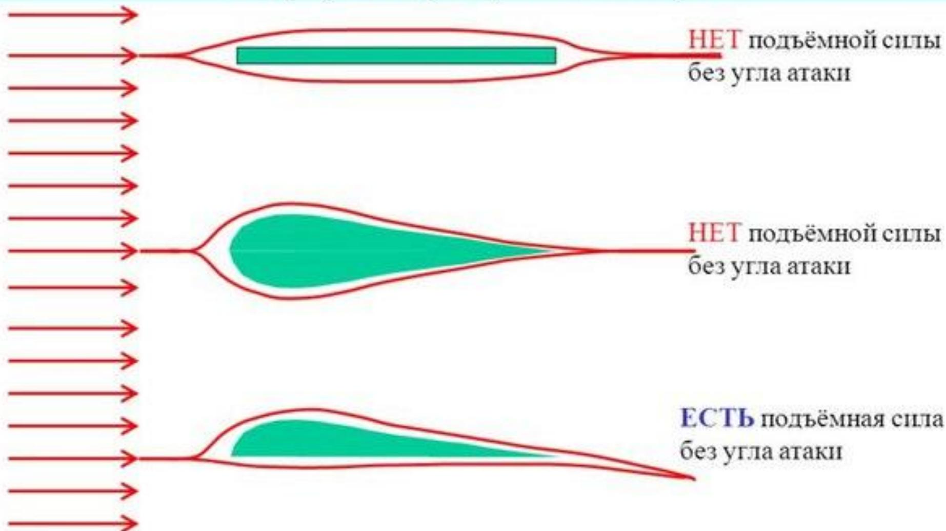
Верхняя часть крыла у самолета изогнута, что заставляет воздух над крылом двигаться быстрее, чем под крылом.
