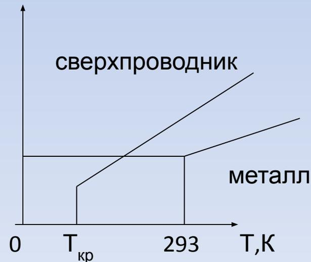
**Сверхпроводимость**, свойство многих проводников, состоящее в том, что их электрическое сопротивление скачком падает до нуля при охлаждении ниже определённой критической температуры  $T_k$ , характерной для данного материала. С. обнаружена у более чем 25 металлических элементов, у большого числа сплавов и интерметаллических соединений, а также у некоторых полупроводников.
