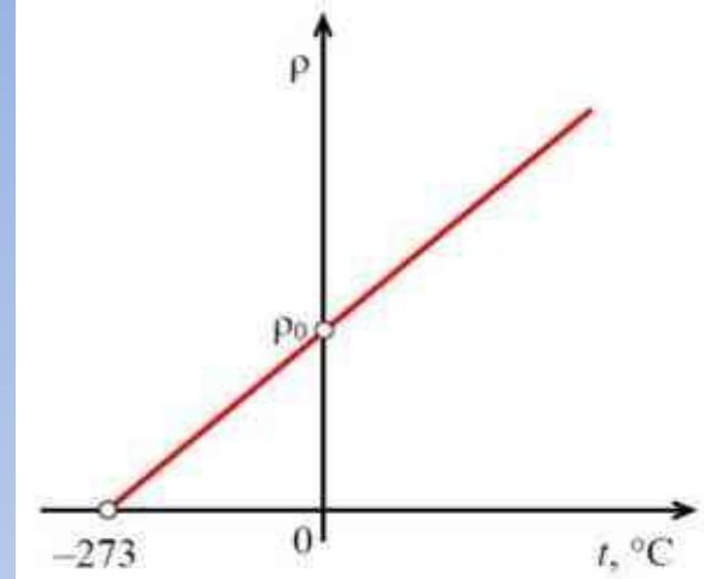
Таким образом, для металлических проводников с ростом температуры увеличивается удельное сопротивление, увеличивается сопротивление проводника и уменьшается эл.ток в
