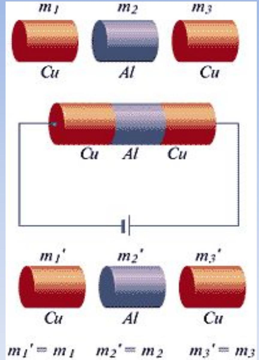
**Электроны взаимодействуют не друг с другом, а с ионами кристаллической решётки. При каждом соударении электрон передаёт свою кинетическую энергию.**
