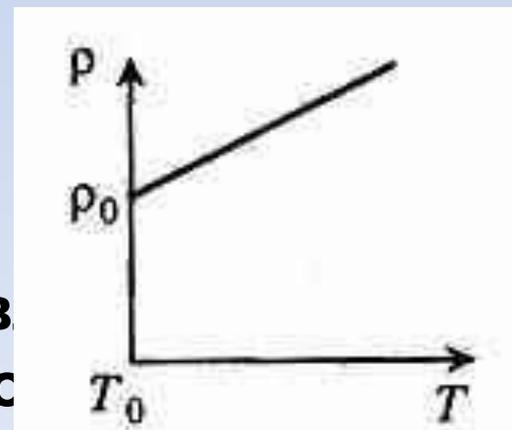
Для всех металлических проводников  $\alpha > 0$  и слабо изменяется с изменением температуры. Для большинства металлов в интервале температур от  $0^\circ$  до  $100^\circ\text{C}$  коэффициент  $\alpha$  изменяется от  $3,3 \cdot 10^{-3}$  до  $6 \cdot 10^{-3}$  (таблица 1).
