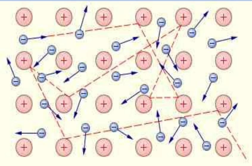
**В металле в отсутствие электрического поля электроны проводимости хаотически движутся и сталкиваются, чаще всего с ионами кристаллической решетки. Совокупность этих электронов можно**
