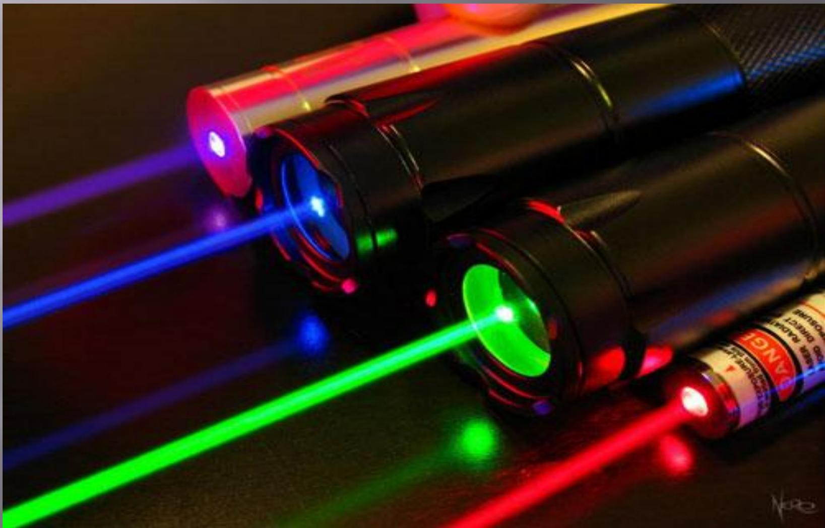
Лáзер — это устройство, преобразующее энергию накачки в энергию когерентного, монохроматического, поляризованного и узконаправленного потока излучения.
