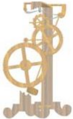
Механизм часов, построенных Галилеем
