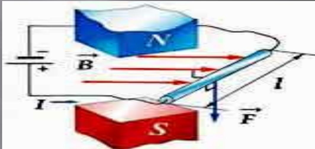
Вектор магнитной индукции всегда направлен по касательной к магнитной линии
