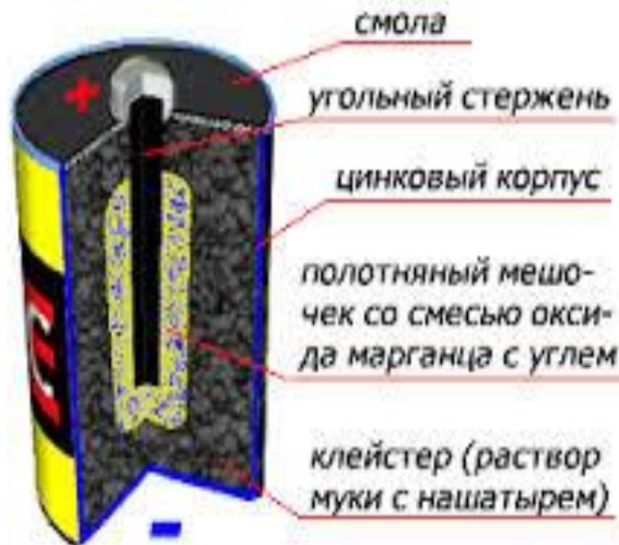
Гальванический элемент – химический источник тока, в котором электрическая энергия вырабатывается в результате преобразования химической энергии окислительно-восстановительной реакции.
