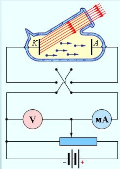
*Фотоэфектом называется явление, состоящее в выбивании светом электронов, находящихся в металле.*
